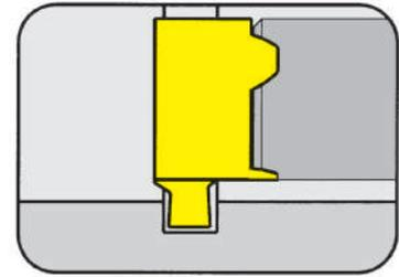
Largeurs pour gorges circlips DIN 471/472
