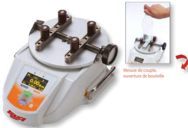
Mesure de couple, ouverture de bouteille
