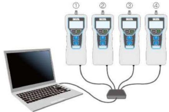
Il est désormais possible de connecter jusqu'à 4 instruments simultanément en utilisant le logiciel optionnel FORCE LOGGER PLUS et collecter sur PC les données, dates et paramètres
