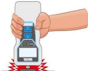
Les dynamomètres DSV & DST en capacité 2N, 5N, 20N et 50N sont équipés du "STOP" mécanique
