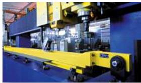
BRE-AUT_MAR pour contrôle et tri des roues de trains, préparation de surface par fraisage
