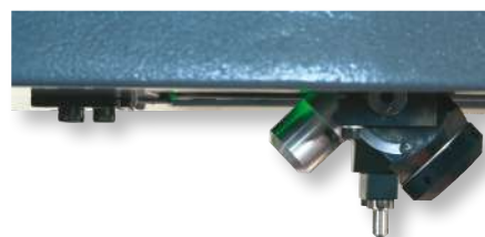
Tourelle porte objectifs et pénétrateurs de haute précision à rotation automatique
