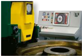
BRE-AUT_MAR pour contrôle et tri des roues de trains, préparation de surface par fraisage
