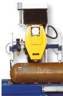
BRE-AUT-SOR pour contrôle en ligne avec préparation de surface par fraisage et lecture automatique de l'empreinte.
