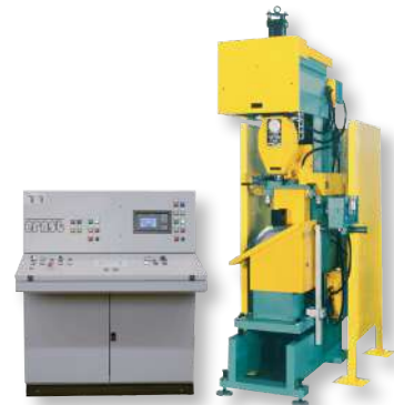
BRE-AUT-SOR pour contrôle en ligne avec préparation de surface par fraisage et lecture automatique de l'empreinte.
