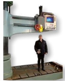
BRE-AUT_WG pour contrôle de plaques, préparation de surface par fraisage avec centre d'usinage
