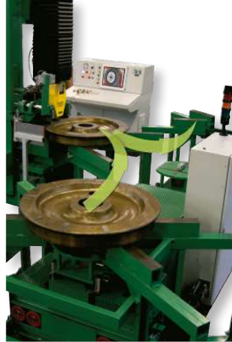
BRE-AUT_MAR pour contrôle et tri des roues de trains, préparation de surface par fraisage
