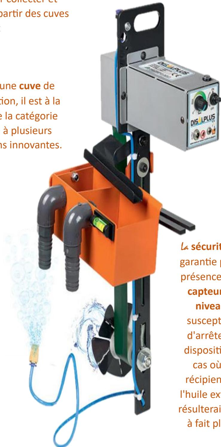
La **sécurité** est garantie par la présence d'un **capteur de niveau**, susceptible d'arrêter le dispositif, au cas où le récipient de l'huile extraite résulterait tout à fait plein.
