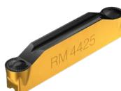
**GC4425 :** excellent équilibre entre une résistance élevée à l'usure et une bonne sécurité d'arête. Pour les opérations de rainurage, de tournage et de tronçonnage dans des conditions stables et à des vitesses de coupe moyennes à élevées.
