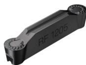
**GC1105/GC1205 :** nuances carbure avec revêtement PVD avec une bonne adhérence et résistance à l'usure en dépouille. La combinaison d'un substrat dur et d'un revêtement permet d'augmenter considérablement la vitesse de coupe.
