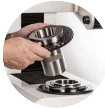
BUSSOLE PORTACONO INTERCAMBIABILI in acciaio temprato di alta precisione con run-out cono  $\pm 2\mu$ . Elevatissima superficie di contatto, quasi 200cm<sup>2</sup>, tra flangia e corpo bussola. Sistema di bloccaggio universale INTERLOCK SYSTEM per una elevata ripetibilità di misurazione.
