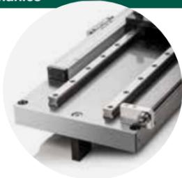
Piastra in ACCIAIO stabilizzato rettificato con planarità  $\pm 2\mu$ . Doppia guida di scorrimento, in classe di precisione SP, con pattino precaricato a ricircolo di sfere.
