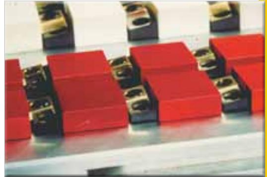
Le crampon effectue le serrage et la face arrière du support sert de butée à la pièce suivante.
