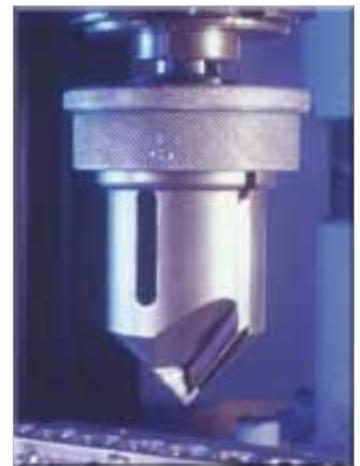
Les Appareils à Chanfreiner KOPAL s'utilisent sur Machine à Chanfreiner ou Perceuse à colonne à Avance Manuel.
