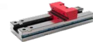
Entrambe le ganasce sono costruite in corpo unico (non esistono slitte o tasselli di fissaggio) per garantire una maggiore rigidità e nessuna flessione. Entrambe le piastre ganasce sono costruite con un angolo di spinta verso il basso. Ciò assicura, nel momento della chiusura, una trazione del pezzo contro la base della morsa (per trascinamento) e di conseguenza un bloccaggio sicuro e preciso.
