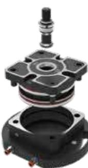
✓ Forza di serraggio 5 ÷ 42 kN / ✓ Forza di arresto fino a 80 kN / ✓ Sbloccaggio ad aria 6 ÷ 7 bar / ✓ Sistema irreversibile / ✓ Compensazione assiale e radiale grazie alla pinza elastica integrale / ✓ Doppio centraggio per tirante per massima rigidità / ✓ Pulizia ad aria / ✓ Chiavetta antirotazione / ✓ Doppio effetto
