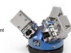
Sono possibili applicazioni con l'utilizzo dello Zero Point anche per lavorazioni di particolari su centri a 5 assi.
