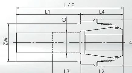
• **Standard** : Ecrou de serrage haute précision DPC **sans** plage de serrage. Concentricité  $\leq 3 \mu\text{m}$  avec pinces de serrage GERC-HP.
