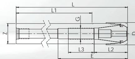
• **Standard** : Ecrou de serrage haute précision MPC **sans** plage de serrage. Concentricité  $\leq 3 \mu\text{m}$  avec pinces de serrage GERC-HP.
