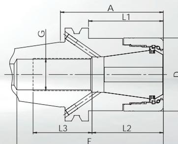
• Le corps du mandrin et l'écrou de serrage sont équilibrés séparément G6,3 à 18 000 1/min
