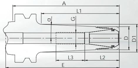
• **Le corps du mandrin et l'écrou de serrage sont équilibrés séparément** G<sub>2,5</sub> à 25.000 1/min ou U ≤ 1 gmm
