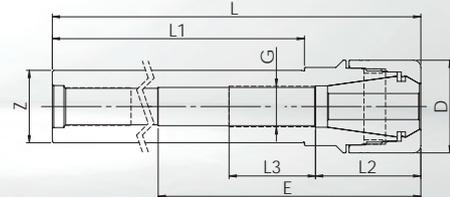
• **Standard** : Ecrou de serrage haute précision DPC **sans** plage de serrage. Concentricité  $\leq 3 \mu\text{m}$  avec pinces de serrage GERC-HP
