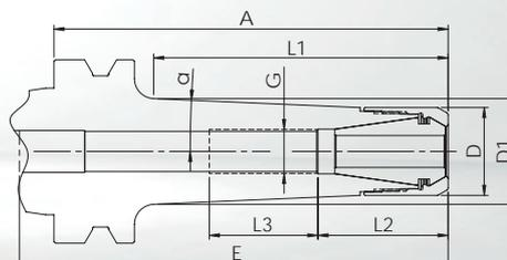
• **Le corps du mandrin et l'écrou de serrage sont équilibrés séparément** G<sub>2,5</sub> à 25.000 1/min ou U ≤ 1 gmm
