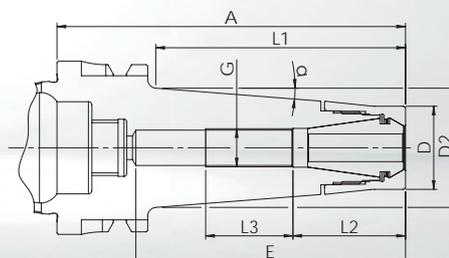
• **Le corps du mandrin et l'écrou de serrage sont équilibrés séparément** G<sub>2,5</sub> à 25.000 1/min ou U ≤ 1 gmm
