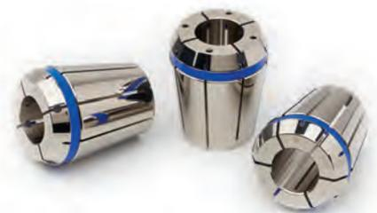
Non seulement les fentes sont ébarbées sur tous les côtés, mais les pinces de serrage disposent aussi d'une profondeur de rugosité moyenne de surface de Rz de 1,6 µm.
