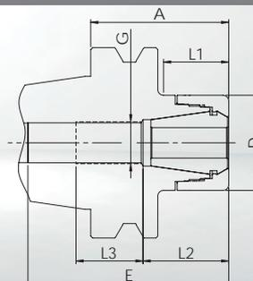
• **Le corps du mandrin et l'écrou de serrage sont équilibrés séparément**  $G_{2,5}$  à 25.000 1/min ou  $U \leq 1$  gmm
