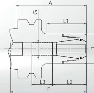
• **Le corps du mandrin et l'écrou de serrage sont équilibrés séparément** G<sub>2,5</sub> à 25.000 1/min ou U ≤ 1 gmm
