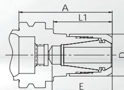
• **Le corps du mandrin et l'écrou de serrage sont équilibrés séparément** G<sub>2,5</sub> à 25.000 1/min ou U ≤ 1 gmm
