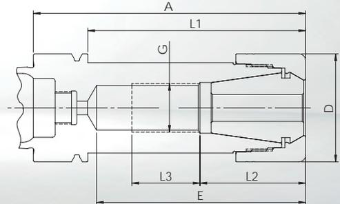
• **Le corps du mandrin et l'écrou de serrage sont équilibrés séparément** G<sub>2,5</sub> à 25.000 1/min ou U ≤ 1 gmm
