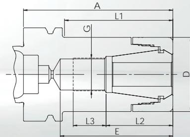
• **Le corps du mandrin et l'écrou de serrage sont équilibrés séparément** G<sub>2,5</sub> à 25.000 1/min ou U ≤ 1 gmm
