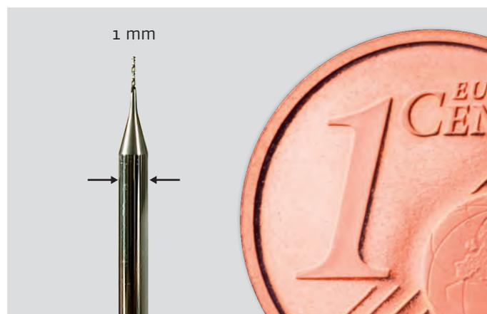
Autre option: il existe une exécution légèrement conique du mandrin Mini Precision MPC pour offrir plus de stabilité tout en conservant sa forme élancée. L'objectif étant une plongée en profondeur dans les pièces à usiner avec p. ex. des angles de dépouille destinés à l'outillage ou au moulage.
