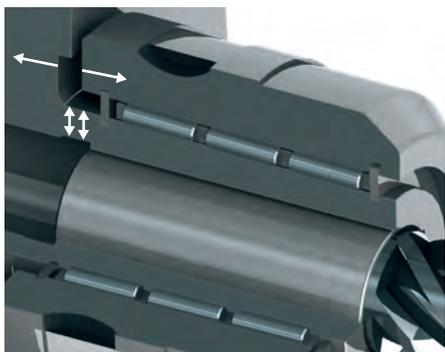
Mandrin fort serrage classique – couple radial transmissible élevé – instable/fragilisé – ne résiste aux contraintes radiales que de façon limitée
