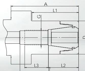
• **Le corps du mandrin et l'écrou de serrage sont équilibrés séparément** G2,5 à 25.000 1/min ou  $U \leq 1$  gmm
