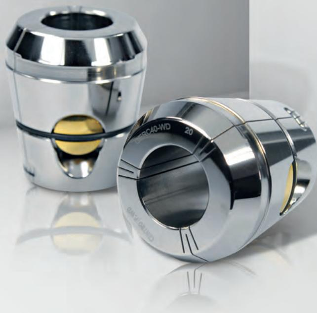
Dorénavant, plus d'extraction ou de micro-dérive de l'outil, et ce à 100 %. La solution est aussi simple que géniale. Il s'agit d'une cale intégrée placée contre la surface Weldon. Ainsi, l'utilisateur a la certitude que même en cas de surcharge du système composé de la machine de fraisage, de la broche, du logement et de l'outil, la pièce à usiner ne subira pas de dommages coûteux.
