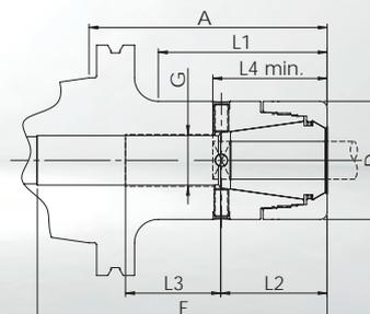
• Le corps du mandrin et l'écrou de serrage sont équilibrés séparément G6,3 à 18 000 1/min
