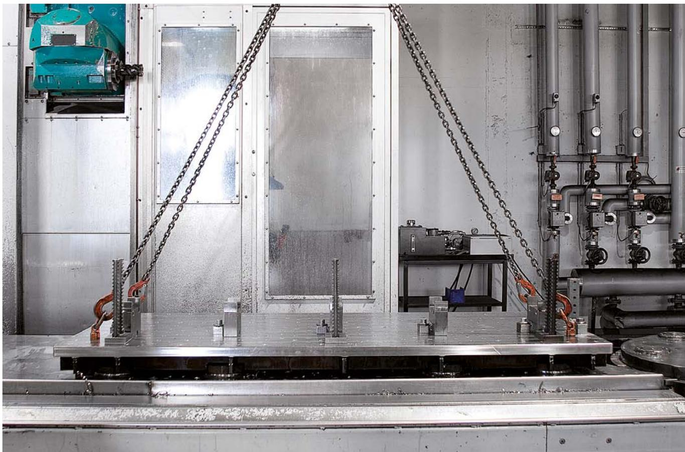
La structure cylindrique des goujons de serrage ainsi que le logement dans le module de serrage garantit un équilibre des tolérances en hauteur et en longueur même sur de longues distances.
