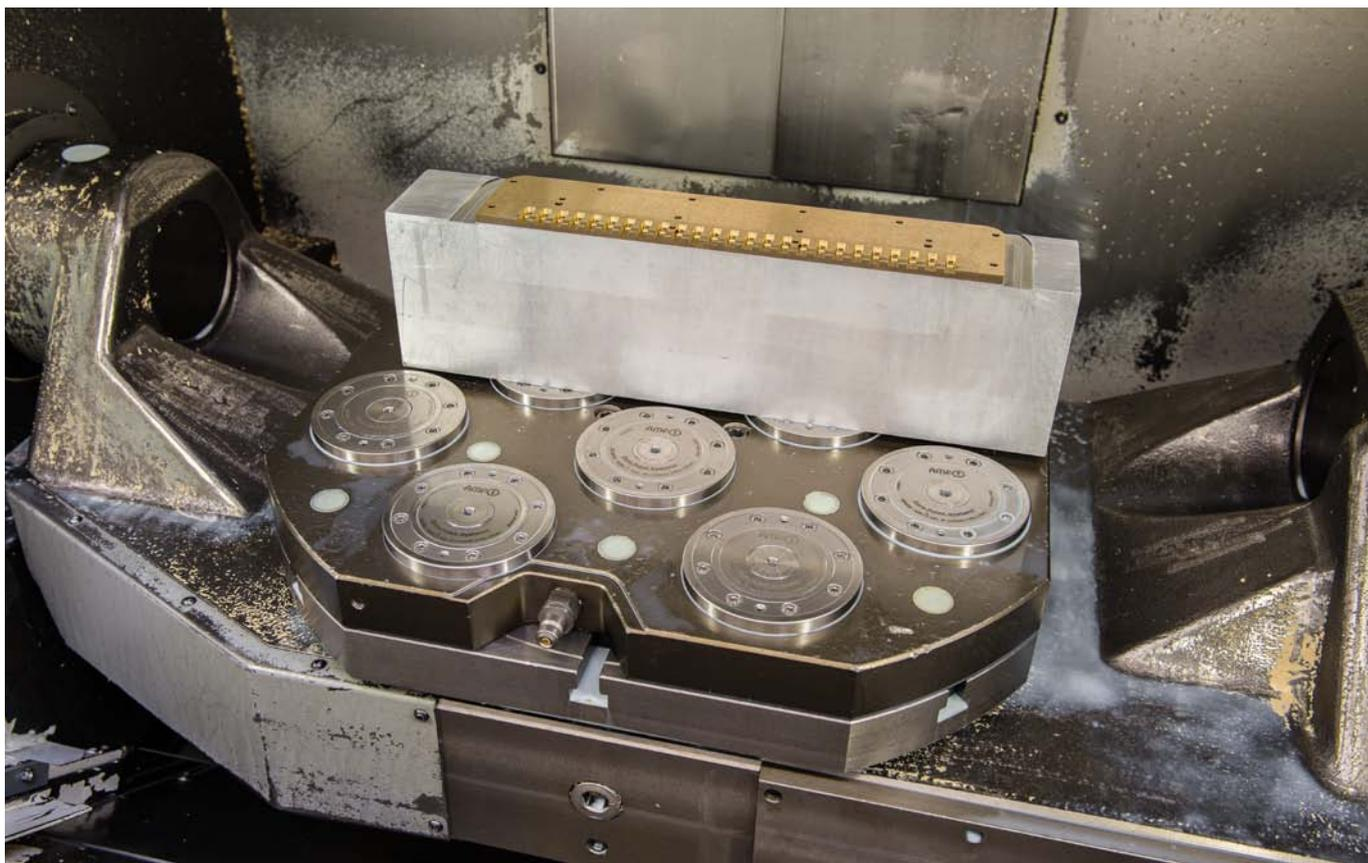
Qu'il s'agisse d'une distance standard entre les modules de 200 x 200 mm ou de tout autre calibre et tout autre agencement des modules de serrage, le Zero-Point-System d'AMF s'adapte à toutes les exigences pratiques.
