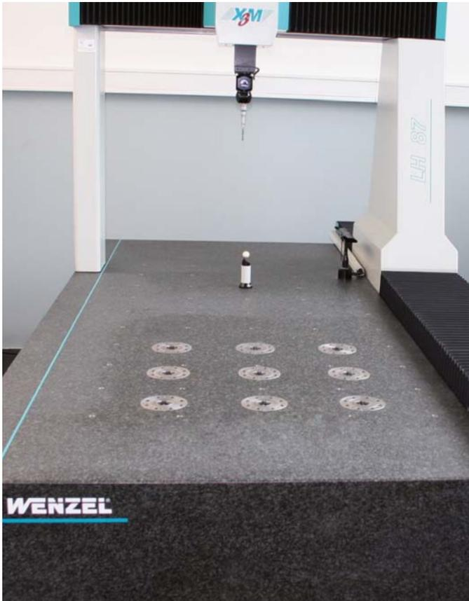
Technique de bridage du point zéro en tant qu'interface unique sur une machine à mesurer les coordonnées. Automatisation même en post-traitement.
