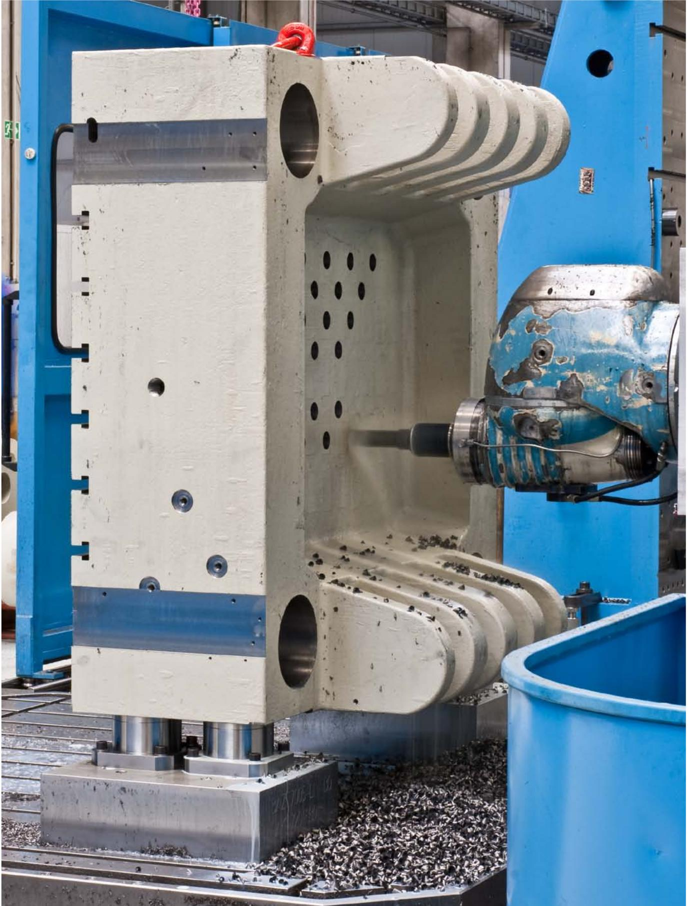
Consoles de serrage de point zéro en application dans l'usinage lourd.
