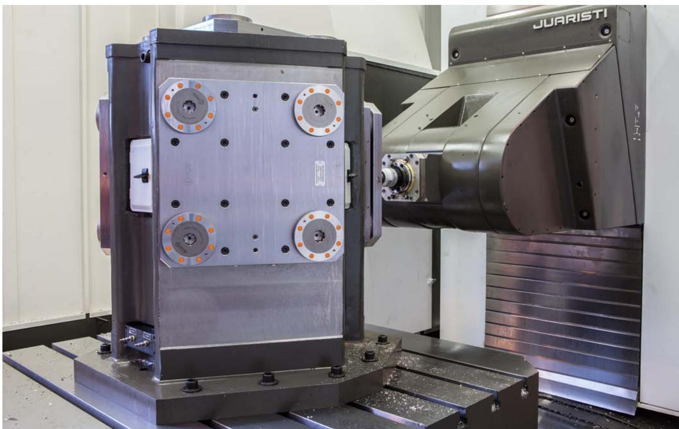
Équerre de fixation avec trois stations de serrage à 4 modules pneumatiques. Grâce à la grande force de traction du Zero-Point-System, le changement de dispositif est simple et convivial même pour les applications horizontales.
