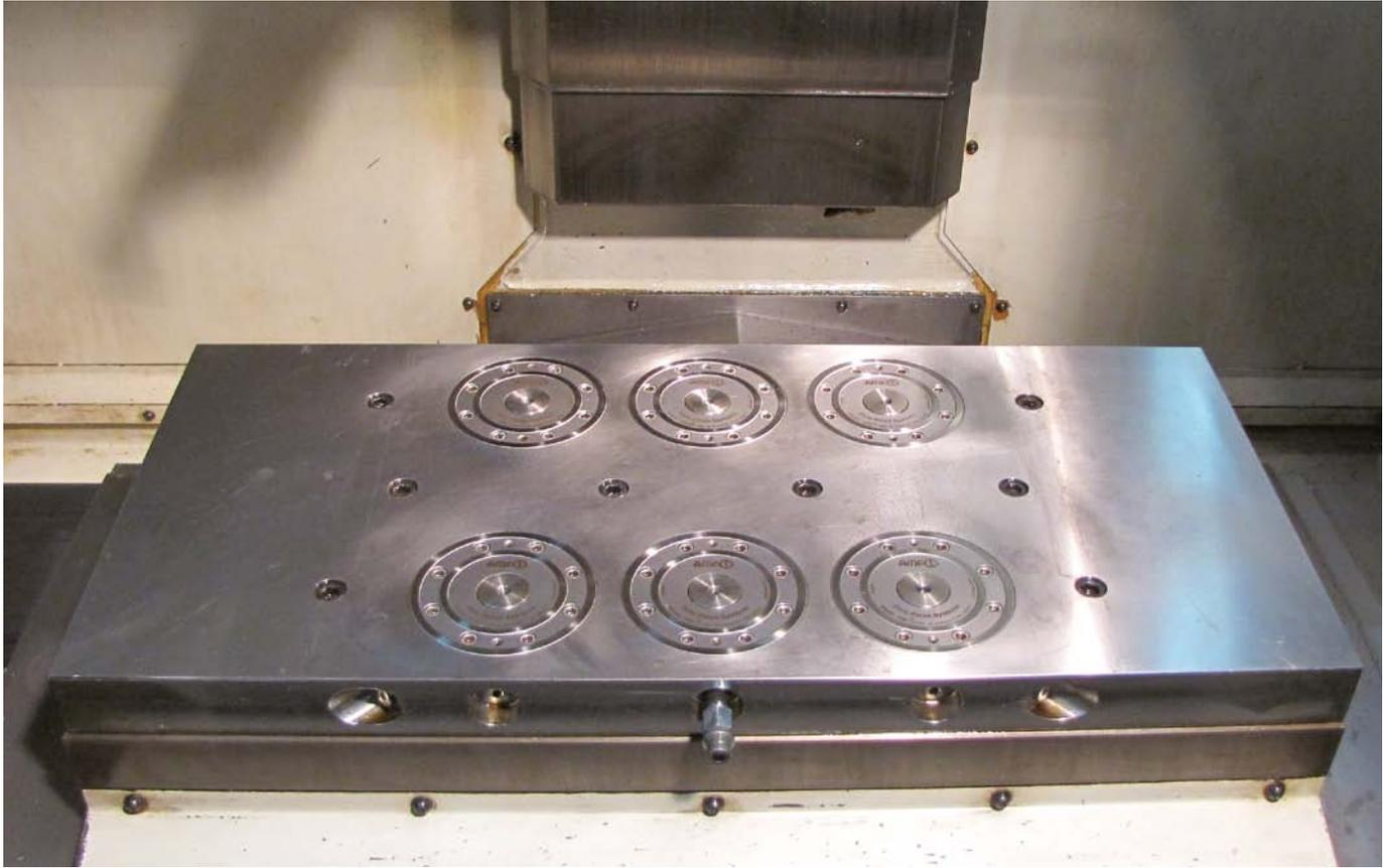
Le logement cylindrique ajusté permet une intégration escamotée des modules de serrage sans perte de précision.
