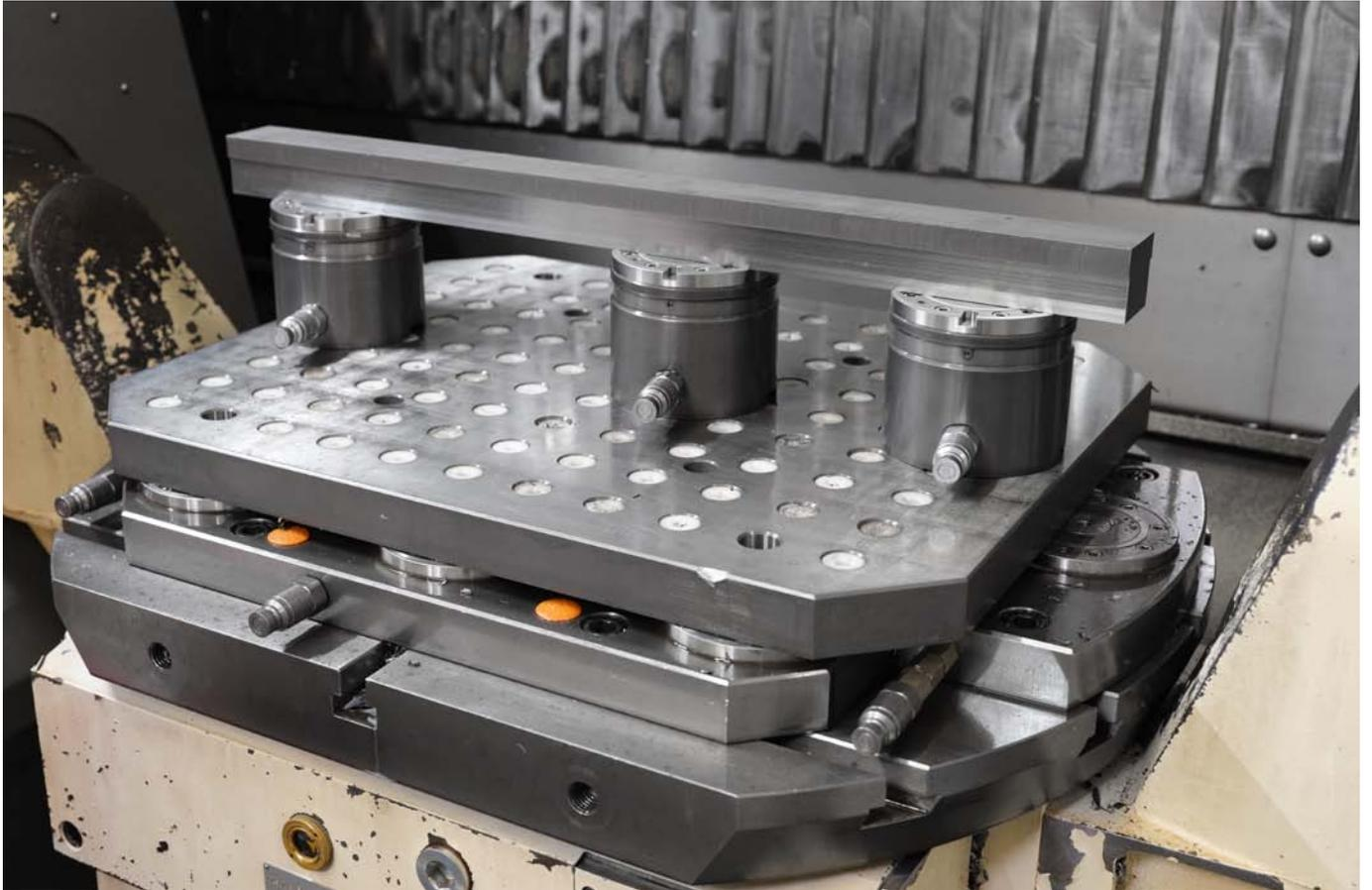
Idéalement accessible pour l'usinage 5 faces grâce à notre technique de bridage du point zéro modulaire.
