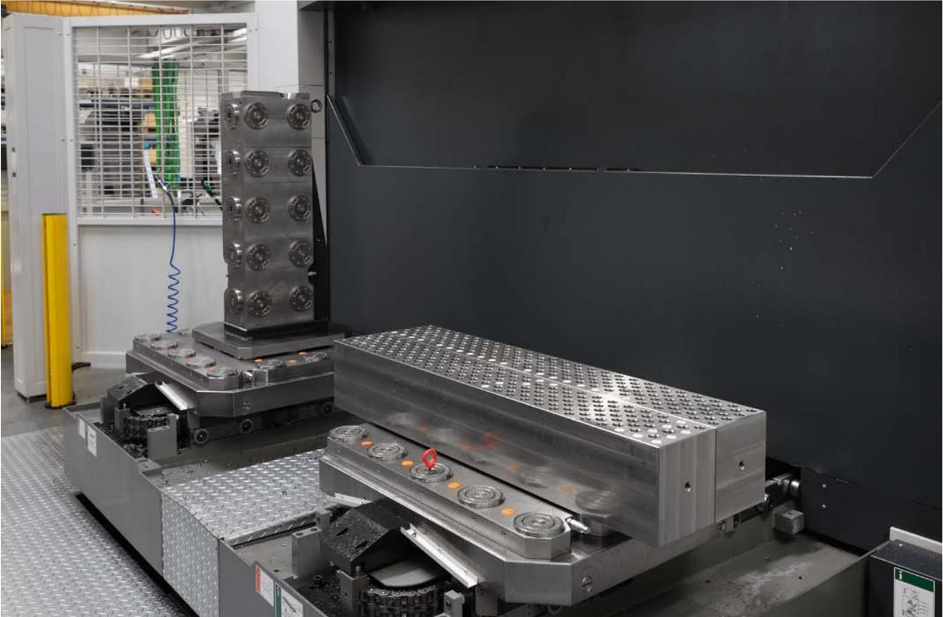
Les forces de maintien élevées et la répétabilité des modules de bridage point zéro d'AMF sont extrêmement importantes, surtout pour la précision des trous profonds.
