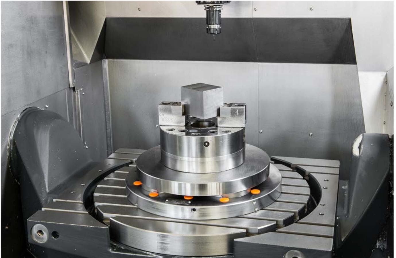
Station de serrage à 4 modules avec contrôle d'appui intégré et contrôle direct du verrouillage pour une utilisation sur des tours et des fraiseuses jusqu'à une vitesse de rotation maximale de 2200 U/min.
