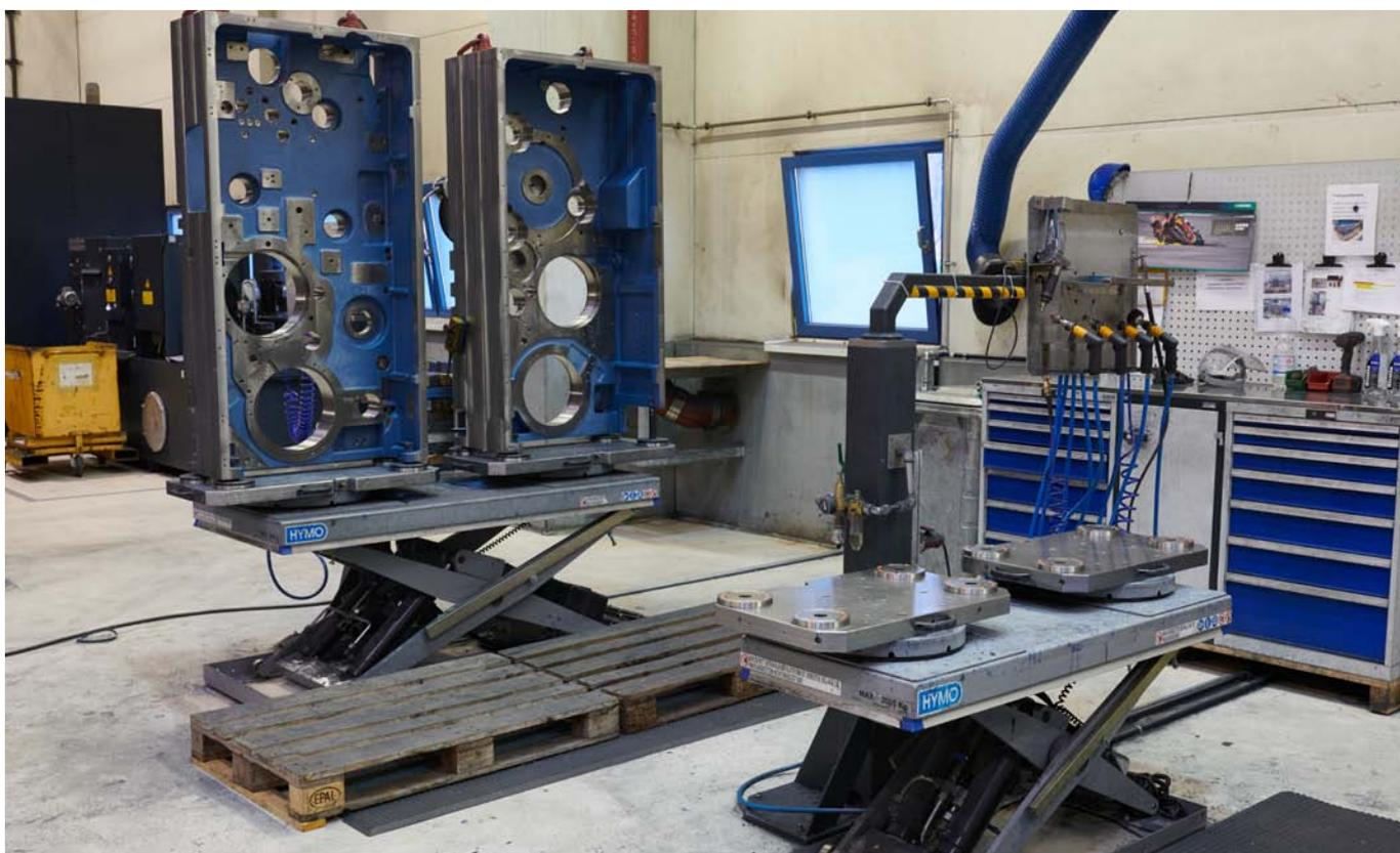
Des tables élévatrices équipées de la technique de serrage à point zéro pour l'ébavurage des pièces. Le processus de fabrication complet a ainsi été optimisé sans faille avec le système Zero Point d'AMF.
