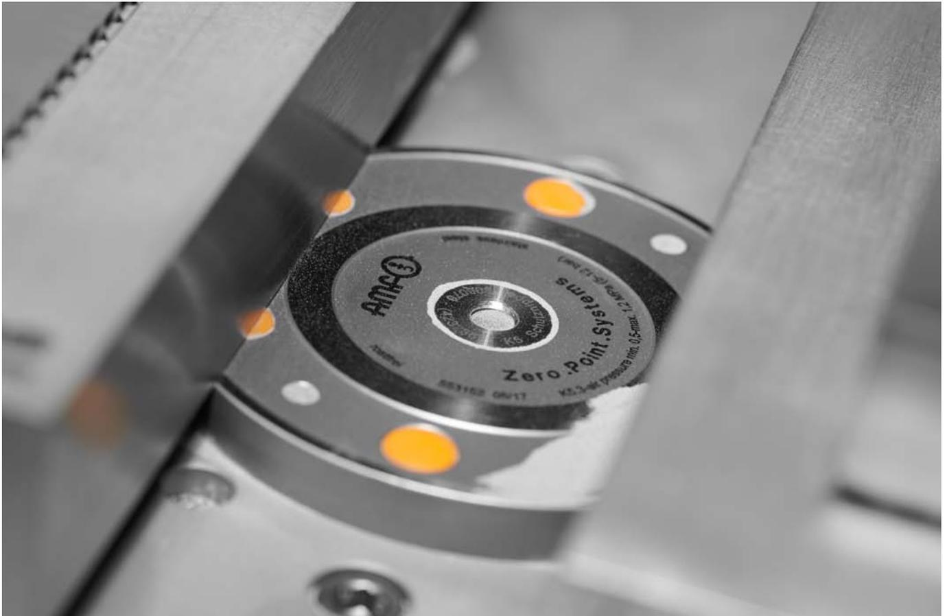
Les modules de bridage point zéro AMF sont spécialement conçus pour l'utilisation dans la fabrication additive et les influences de température élevées qui en résultent. Ils sont complètement étanches et ainsi non sensibles aux actions de la poudre métallique.
