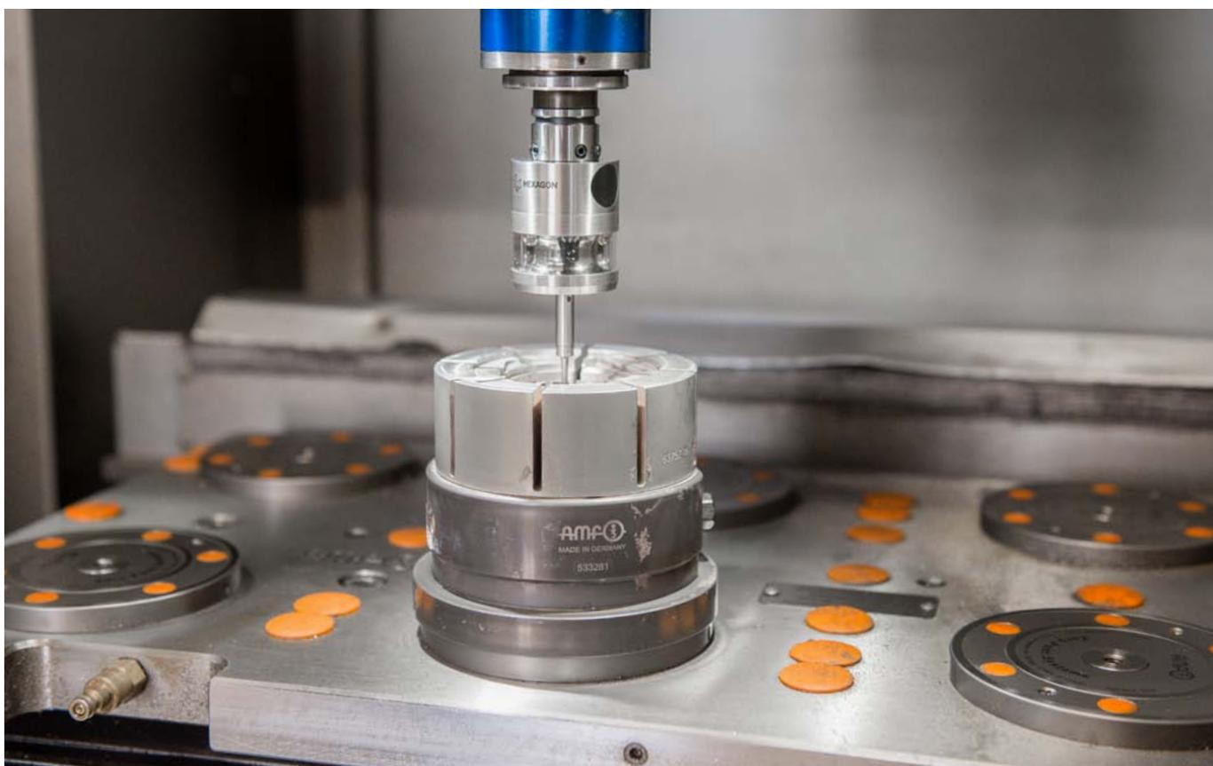
La pince de serrage mécanique est serrée directement avec la technique de bridage du point zéro.
