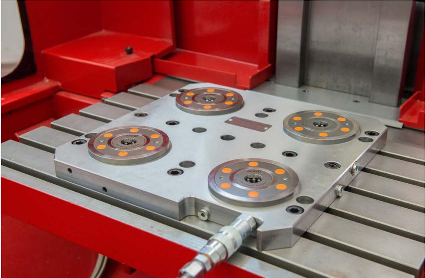
Utilisation de différentes tailles de modules de serrage standard dans une application.
