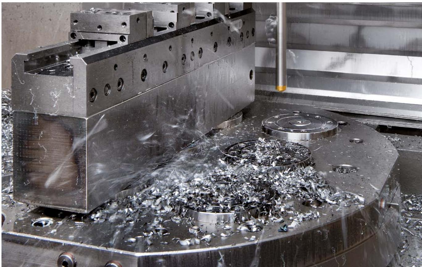
L'AMF-Clean-Stick mis en œuvre : nettoyage automatisé du dispositif de bridage et de la table de machine.
