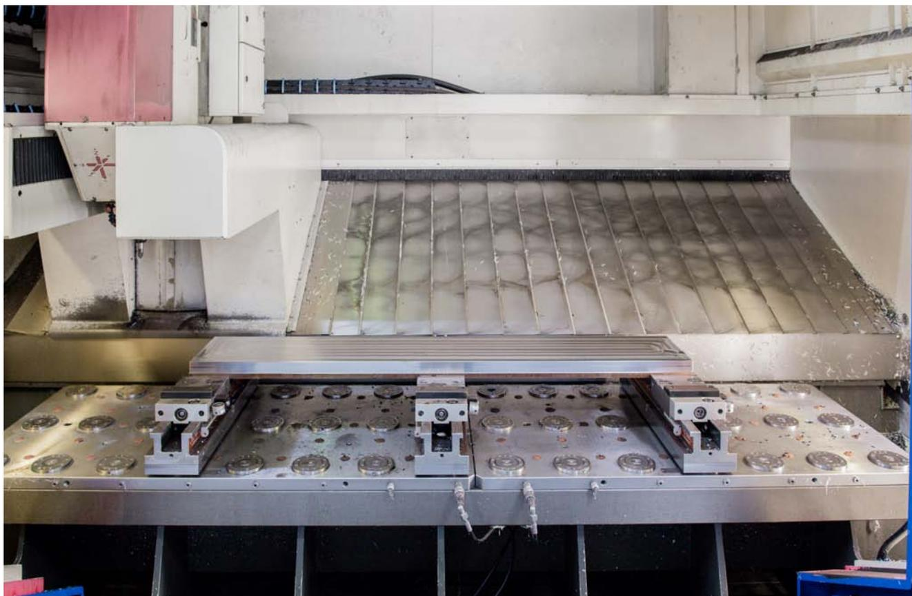
Système de bridage du point zéro mécanique modulaire dans la fabrication d'outils et de moules.
