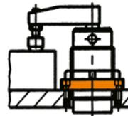
Avec bride filetée et écrou à encoches
