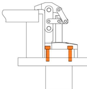
Par le haut avec quatre vis à tête cylindrique
