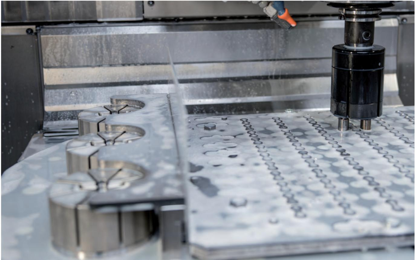
Les cycles de travail sans surveillance peuvent être réalisés facilement. Le préhenseur AMF manipule des pièces à usiner entre la réserve de pièces et les trois pinces de serrage. Le système de bridage et la réserve sont serrés au moyen d'un système de serrage à point zéro.
